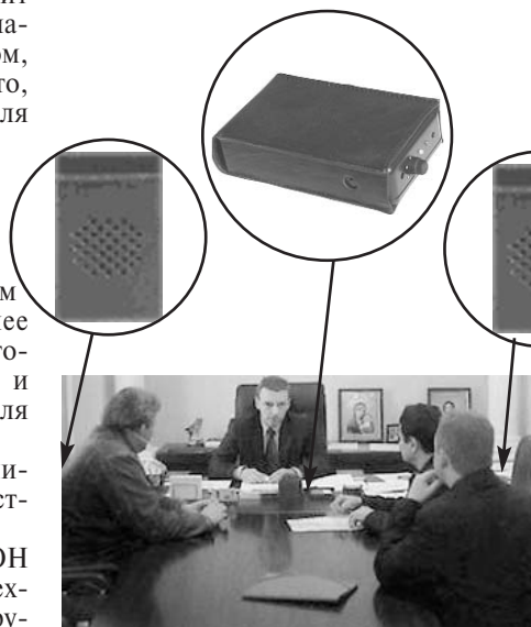
Рис.2. Типовое размещение элементов изделия АДВОКАТ-3 АВТО в офисе при проведении конфиденциальных совещаний
