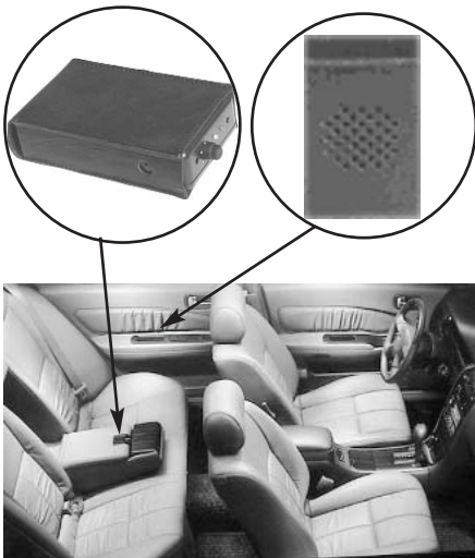
Рис. 3. Возможное расположение элементов изделия АДВОКАТ-3 АВТО для обеспечения конфиденциальных переговоров в салоне автомобиля
