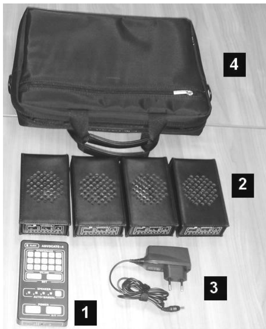
Рис.1 Внешний вид и комплектация изделия АДВОКАТ-4
