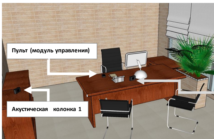
Рис.5 Пример расположения элементов изделия АДВОКАТ-3 КОМФОРТ в кабинете руководителя
