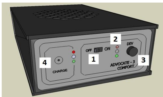
Рис. 2 Передняя панель радиоуправляемой акустической колонки изделия АДВОКАТ-3 КОМФОРТ
