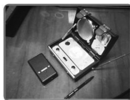
PSP-2AM AUTO Pocket Speech Protector Acoustic 2AM Миниатюрное персональное устройство акустического противодействия в офисе и автомобиле
